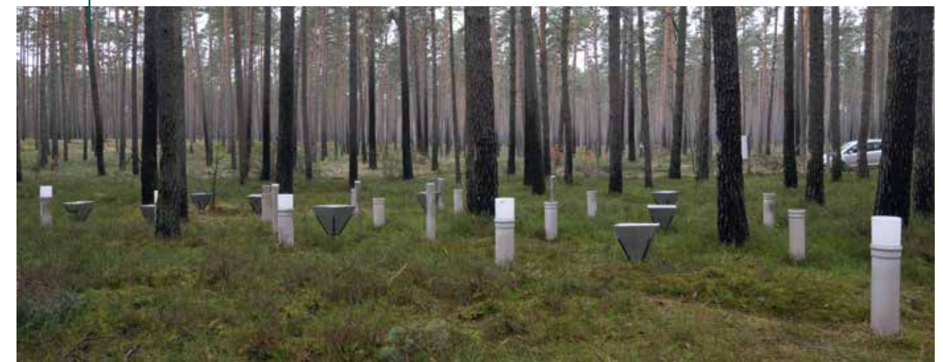
Forstliches Umwelt-Monitoring: Streufall-, Depositions- und Niederschlagssammler.
